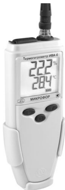
Рис.5. Настенная установка блока индикации ИВА-6АР на кронштейне.
